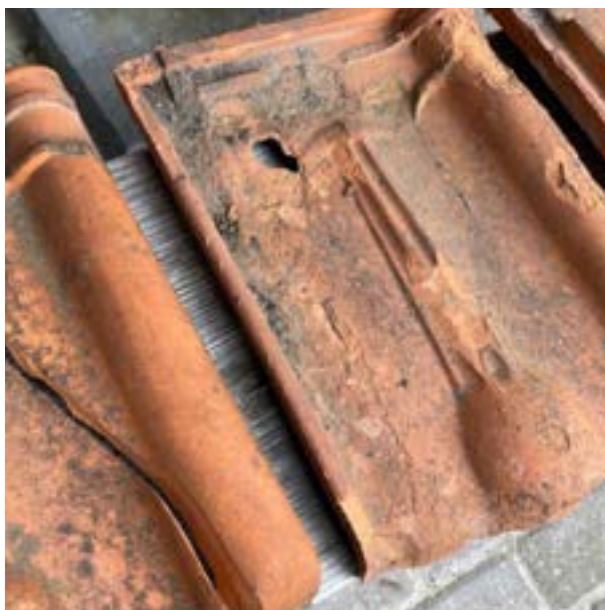
Keramische dakpannen zoals deze kruispannen kunnen meestal zeker wel 75 jaar mee, maar op een gegeven moment zijn ze op, zoals hier is te zien.
