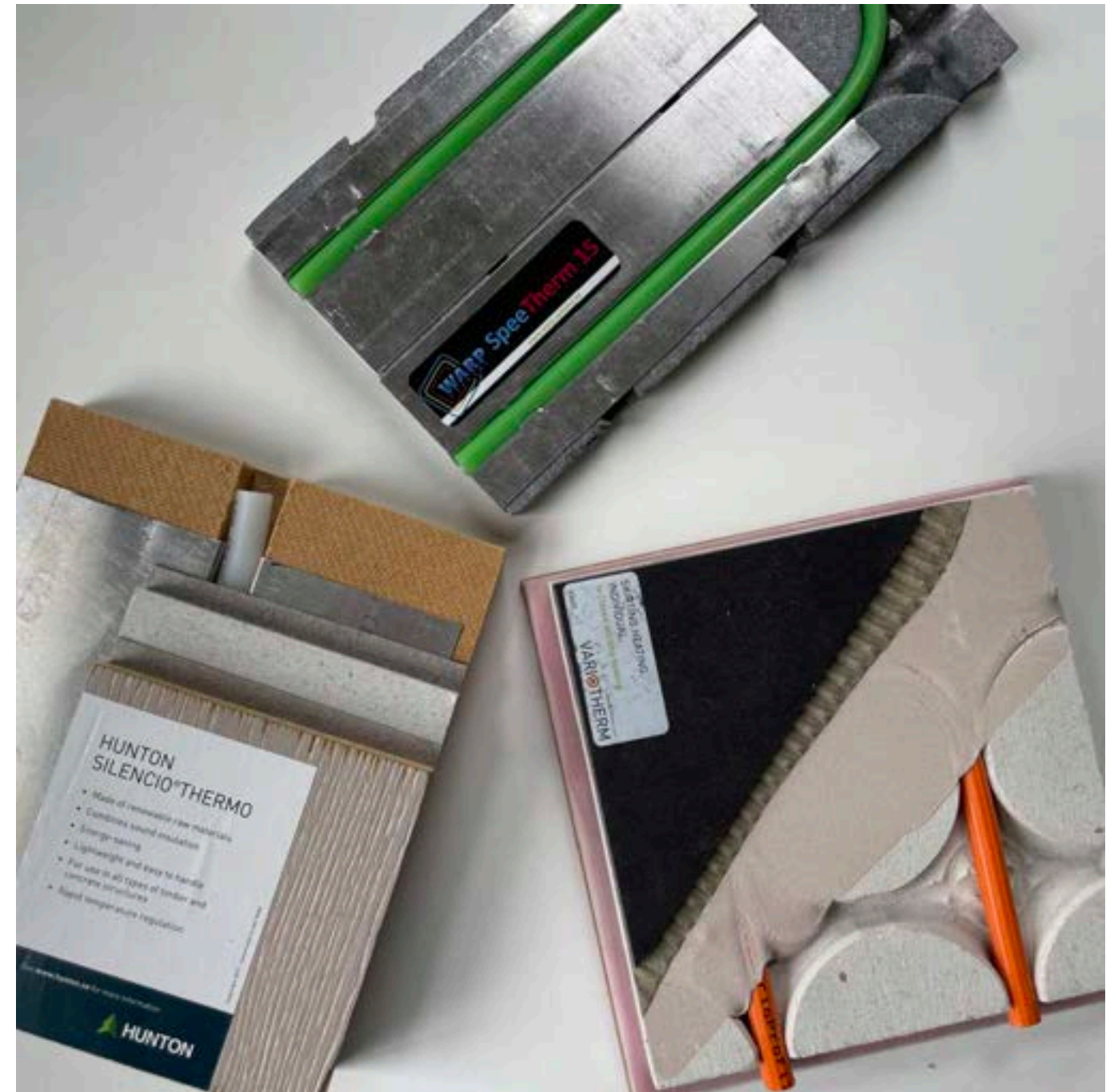
▲ Afbeelding 19 Meestal is in een extra dikte van het vloerpakket van 2,5 tot 4cm al een (droogbouw)vloerverwarming haalbaar, op de bestaande houten vloer. De beschikbare droogbouwverwarmingssystemen bestaan uit platen, meestal al met sleuven of noppen waarin de verwarmingsbuizen direct aan te brengen zijn. Gebruikelijke materialen voor de platen zijn gipsvezelplaat, stro- of houtvezelplaat of EPS. Vaak liggen de buizen in aluminium platen die aan de bovenzijde de warmteafgifte verbeteren doordat ze een groter verwarmingsoppervlak vormen. De buisdiameter is afhankelijk van de gebruikte plaat 10 tot 16mm.
